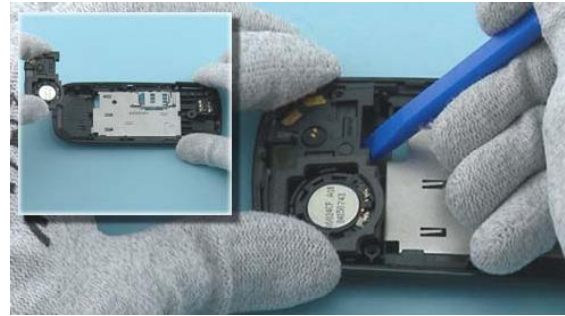
14) Use the SS-93 to remove the ANTENNA MODULE.
